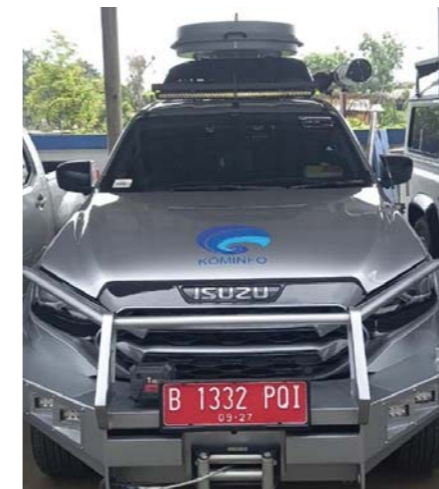
Stasiun Bergerak Mon/DF R&S ESMD (Mobil SUV Merk Isuzu tipe MUX)
