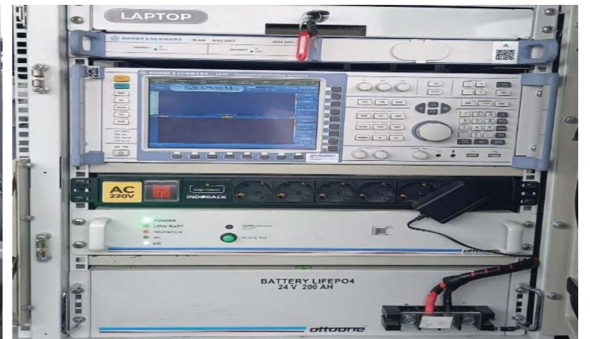
Stasiun Bergerak Mon/DF R&S ESMD (Mobil SUV Merk Isuzu tipe MUX)
