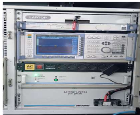
Stasiun Bergerak Mon/DF R&S ESMD (Mobil SUV Merk Isuzu tipe MUX)
